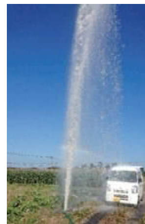
給水栓破損による漏水
