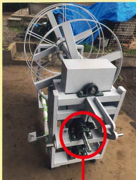
PTO軸とトラクターを接続
